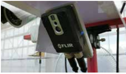
La cámara de infrarrojos FLIR AX8 observa de manera continua el crecimiento de las cosechas.
