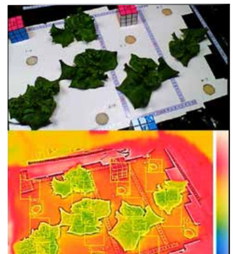
La cámara termográfica de infrarrojos FLIR AX8 produce imágenes térmicas de 80 x 60 píxeles, junto con información de temperatura.
