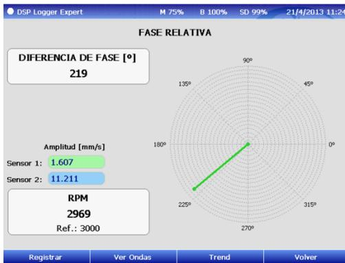
La diferencia de fase relativa se muestra en un recuadro arriba en la pantalla de medición, este campo será el indicado para realizar los diagnósticos de máquinas.
