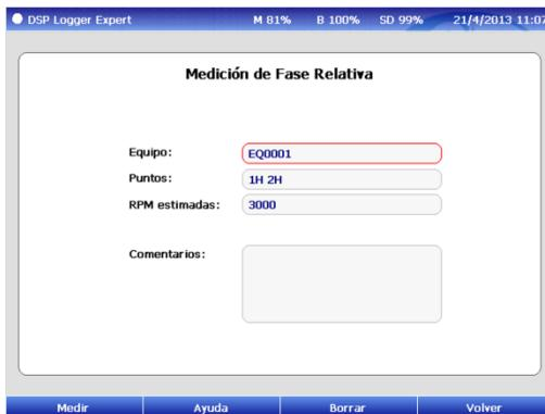
En la primera pantalla, se ingresan los datos del equipo a analizar y los puntos del mismo donde se colocaran los sensores. Las RPM estimadas de la máquina y algún comentario que sea útil a l generar el reporte.
