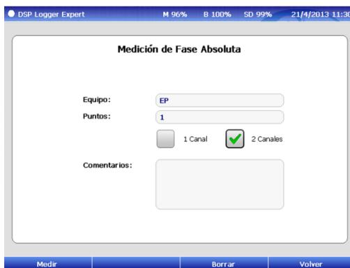
En la primera pantalla, se ingresan los datos del equipo a analizar y los puntos del mismo, donde se colocaran los sensores.
